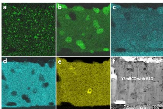
FIG. 3. EDS elemental map (a) Zr, (b) Y, (c) (d) Sm, (d) Ba, (e) Cu and (f) the corresponding region.
